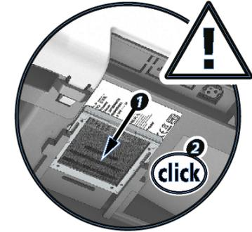
3 Setzen Sie den Filter wieder ein. Filter in seinen Steckplatz einlegen (die Kerbe zeigt zu Ihnen) und ihn gerade nach unten schieben, bis Sie einen Klick hören.
